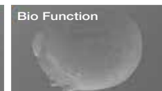
Images MEB (50x) - L'abrasion d'Enamel Plus HRi Bio Function est similaire à l'or et donc à celle de l'émail naturel.
